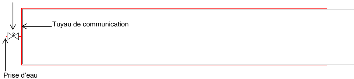
Figure 6 Schéma de la configuration de la conduite d'eau des deux côtés de la remorque (vue de dessus)
