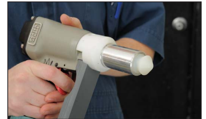
■ Le pistolet Zephyr-E en position déclenchée, exposant la tête conique de sa cheville percutante
