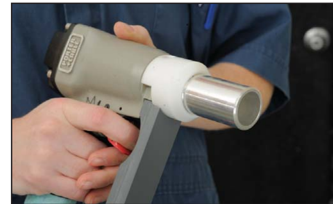
■ Le pistolet Zephyr-E en position amorcée, avec sa cheville en retrait dans le cylindre du canon
